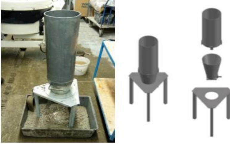
Şekil A.3 Modifiye koni çıkış testi için ekipman (örnek)
