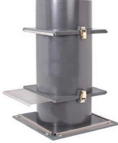
Şekil A.5 ASTM C1610'a uygun olarak statik ayırma testinin düzenlenmesi
