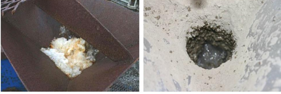
Şekil 5.5 Islanmış polimerle tıkanmış hazne (sol); kısmen ıslanmış mineral ürün oluşumu (sağ)
